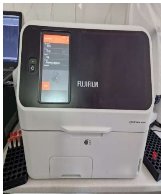
б) Аналізатор FUJI DRI-CHEM NX600
